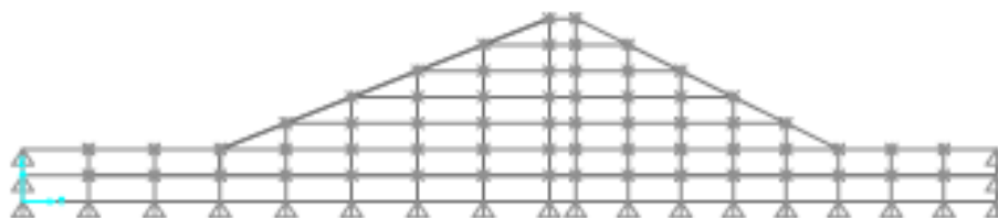
Fig. G11. Schema de discretizare în elemente finite.
