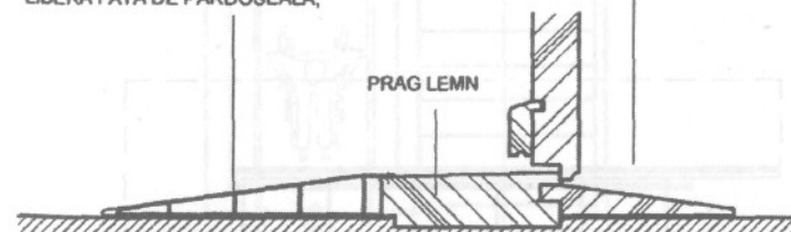
Fig. 2. Racordarea pardoselilor din materiale diferite cu trecere peste un prag de lemn
