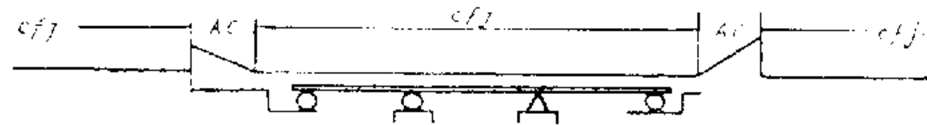
(b) Pod metalic cu aparate de compensare
